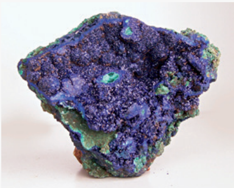
＞ 蓝铜矿（蓝色矿物）与孔雀石（绿色矿物）共生标本 孔雀石与蓝铜矿同为孔雀石族矿物，成分相似、结构相同，常共生 蓝铜矿的稳定性不如孔雀石，在地表环境下很容易因风化作用而转变成孔雀石
